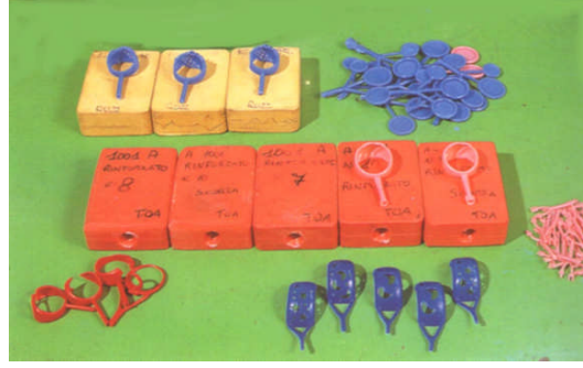
Resim 2.3: Mum basma işlemi yapılmış mum modeller
